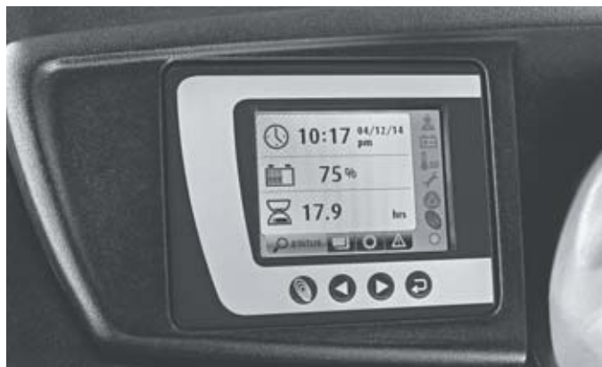
Il display a colori e l'unità di comando visualizzano lo stato della batteria, la direzione di marcia oltre a informazioni aggiuntive
