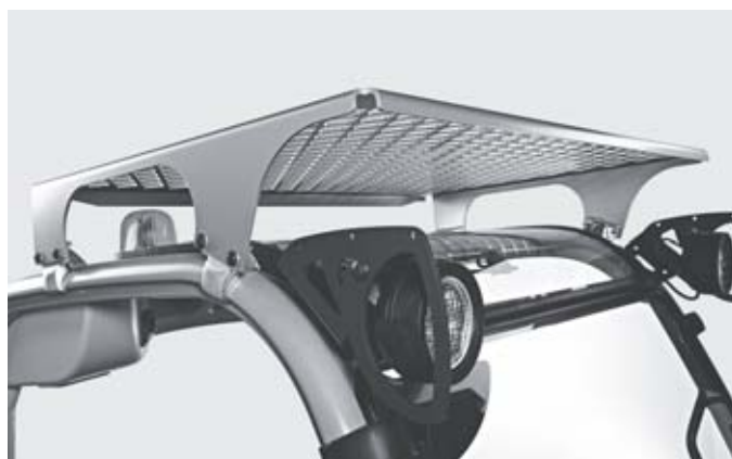
Tettuccio con griglia di protezione aggiuntiva
