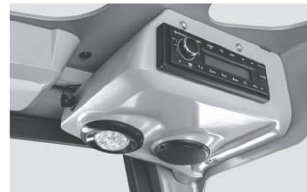
Luce da lettura e radio con sistema vivavoce e altoparlanti
