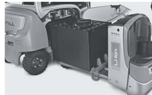
Sostituzione della batteria con transpallet elettrico
