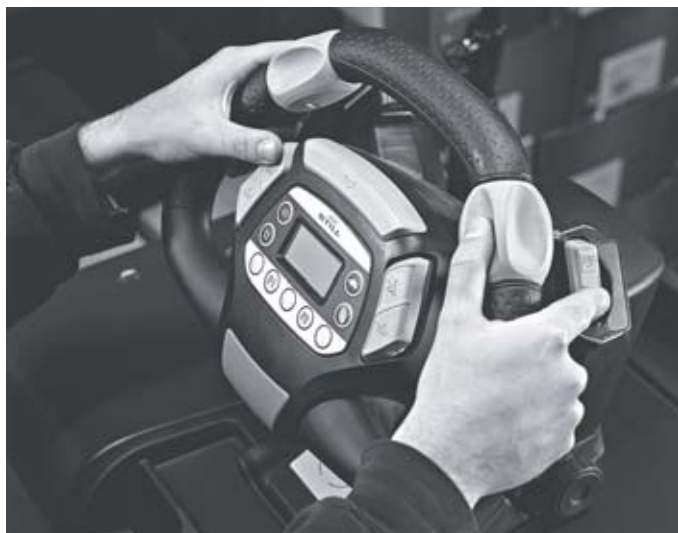
Volante esclusivo STILL Easy Drive per un migliore comfort di guida e uso di tutte le funzioni senza togliere le mani
