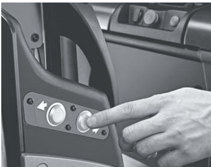
Funzionamento da terra su entrambi i lati per capacità di movimentazione in caso di elevata frequenza di prelievo
