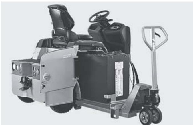
Sostituzione laterale della batteria
