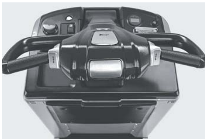
Postazione di lavoro del conducente con elementi di comando ergonomici ed intuitivi
