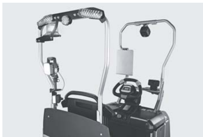
Staffa per accessori opzionali per molteplici possibilità d'uso e varianti di dotazione con lampeggiante e fari di lavoro
