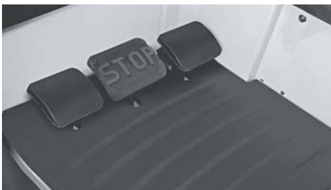
Pedali per il rapido cambio di direzione
