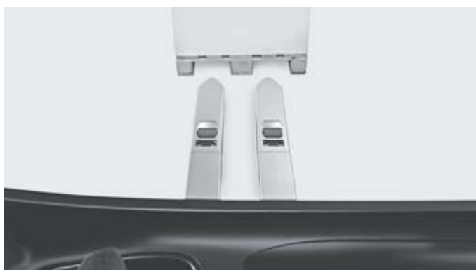
Visuale ottimale della punta delle forche per inforcare il pallet più facilmente
