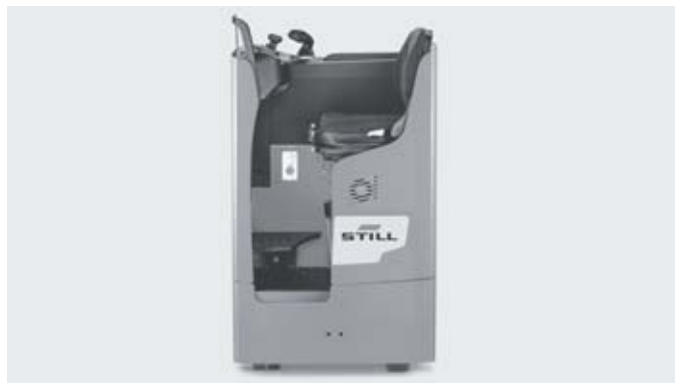
Pedana regolabile in altezza per impostazioni personalizzate del conducente
