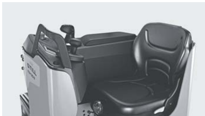
Sedile del conducente imbottito regolabile in base al peso dell'operatore per assicurare il massimo comfort
