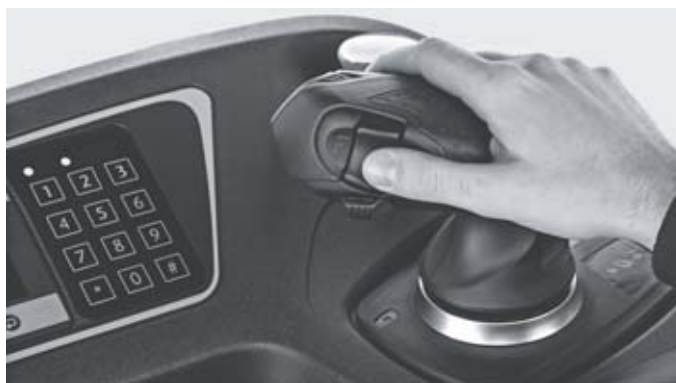
Joystick 4Plus opzionale per il sollevamento, l'abbassamento e il controllo della trazione senza dover cambiare mano
