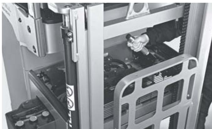
Sostituzione della batteria laterale di serie per la massima disponibilità del carrello
