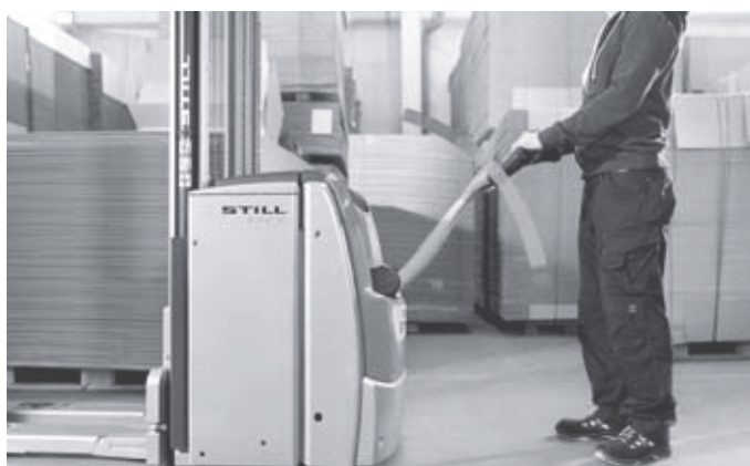
Sicurezza nella movimentazione: a seconda dell'angolo del timone, la velocità viene automaticamente adattata alla distanza tra l'operatore e il carrello elevatore
