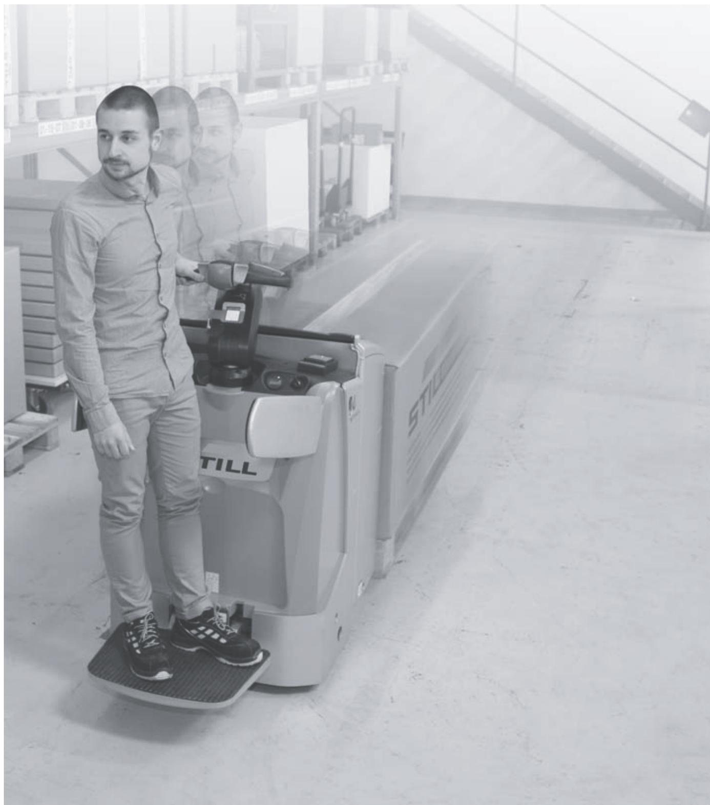
Ancora più prestazioni: l'opzione DRIVESpeed rende l'EXU-SF 20 ancora più potente. Grazie ad un unico telaio con due ruote scolpite a smorzamento idropneumatico, la velocità massima può essere aumentata fino a 10 km/h. Allo stesso tempo anche la stabilità in curva è migliorata.
