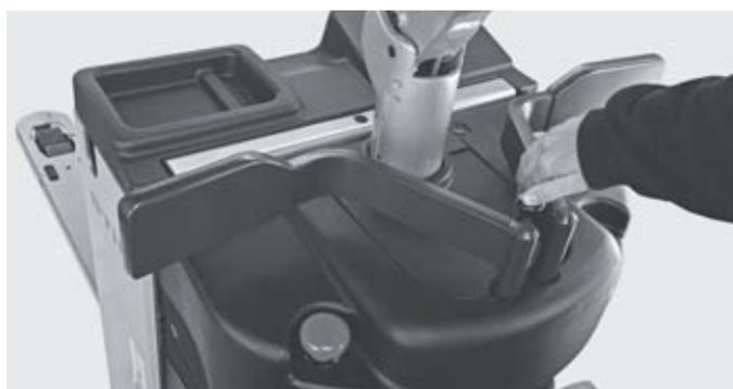
Sicurezza a 360°: le protezioni laterali opzionali possono essere richiuse facilmente e rapidamente, preservando la stabilità e la sicurezza dei conducenti e fornendo la protezione ottimale in tutte le situazioni di guida
