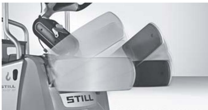
Sicurezza a 360°: le protezioni laterali regolabili in altezza mantengono il conducente stabile e sicuro, fornendo una protezione ottimale in tutte le situazioni di guida
