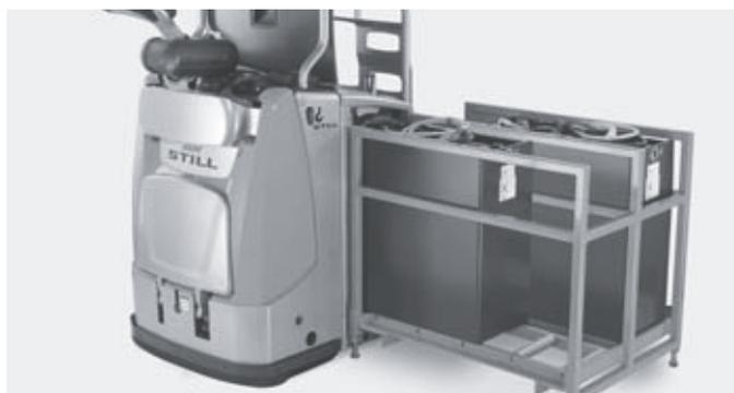
Cambio batteria semplificato: cambio batteria laterale opzionale per una migliore sicurezza ed ergonomia senza l'uso di gru o paranchi
