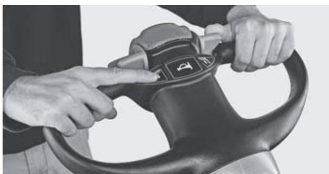
Controllo ergonomico e intuitivo: sollevamento e processi di sterzata possono essere controllati con una sola mano, da parte anche di operatori mancini
