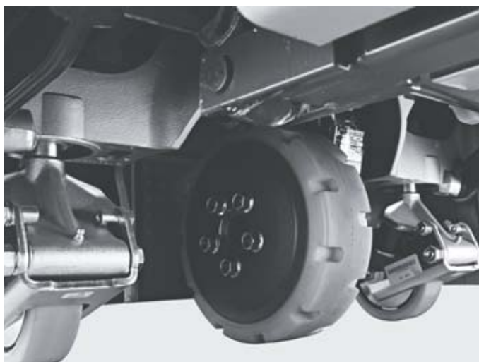
Telaio robusto e ruote di supporto idrauliche per spostarsi senza difficoltà anche sulle rampe
