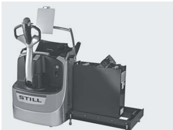
Massima disponibilità grazie alla sostituzione laterale della batteria
