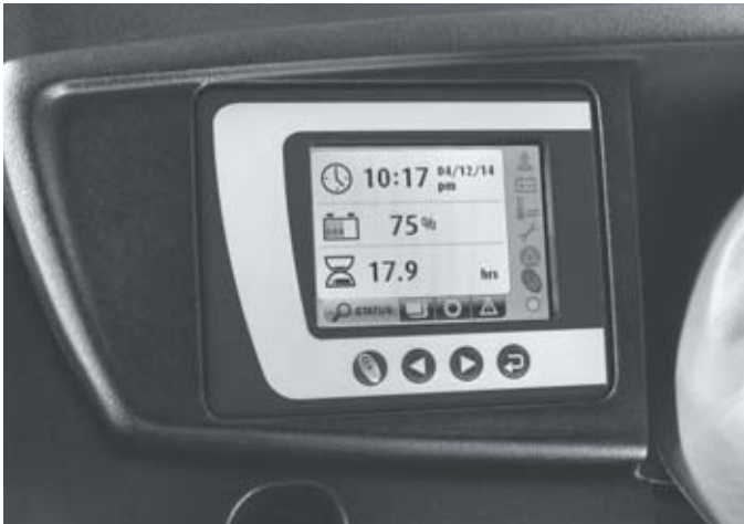
Tutto sempre in vista: display a colori con una serie di simboli non linguistici che indicano immediatamente tutte le funzioni importanti
