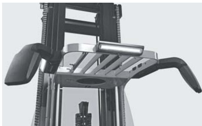
Diverse possibilità di allestimento cabina con Luci a LED, specchietti integrati e ventole
